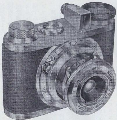
フアインダーの横には、ホルダーがネジ込んでありますから、フィルターをこのホルダーに入れて置けば、使用する時はホルダーごと外してレンズ前面部、シャッター枠の内側にネジ込んで使ひます。このホルダーには、専用のレンズフードも取り付きますから、従來の様にフードやフィルターホルダーを、外側に單にはさみ込むとは違つてずつと確實な取り付けが出来、良くある失敗、……フードが曲つて取り付けられた爲(氣の付かない程度にでも)寫つた寫眞は隅がケラレて(隅が黒くふちどられる)折角の寫眞を臺無しにする……等と言ふことが絶対にありません。
