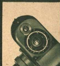
機體上部にあるM式ロール回轉表示器を示す
