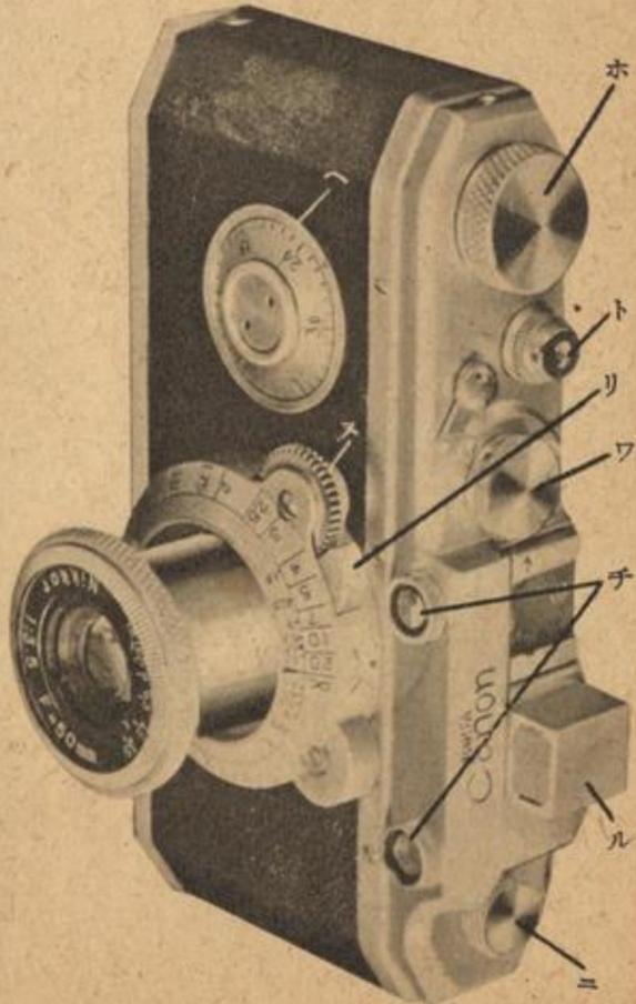
さて鏡玉はどう抽出するかを申しますと第一に外側のキザキザの部分——これを廻せば絞ります——をもち軽く引抜きます。すると鏡筒に圖のやうな▼印の——が現はれますから——を∞印と合せ尙止るところまで引出します。
