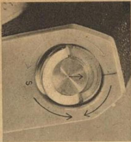
装填は、カメラの底蓋を明け、そこからマガジンに納つたフィルムを嵌込む譯ですが、底蓋は右圖の如く、キーについた矢印をOに合せ軽く引くと開きます。そしてマガジンとスプールを出します
