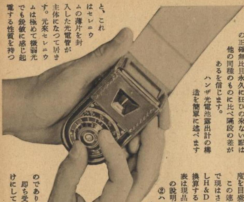
と、これはセレンウムの薄片を封入した光電管が主体になつて居ます。元來セレンウムは極めて微弱光でも鋭敏に感じ起電する性質を持つ
