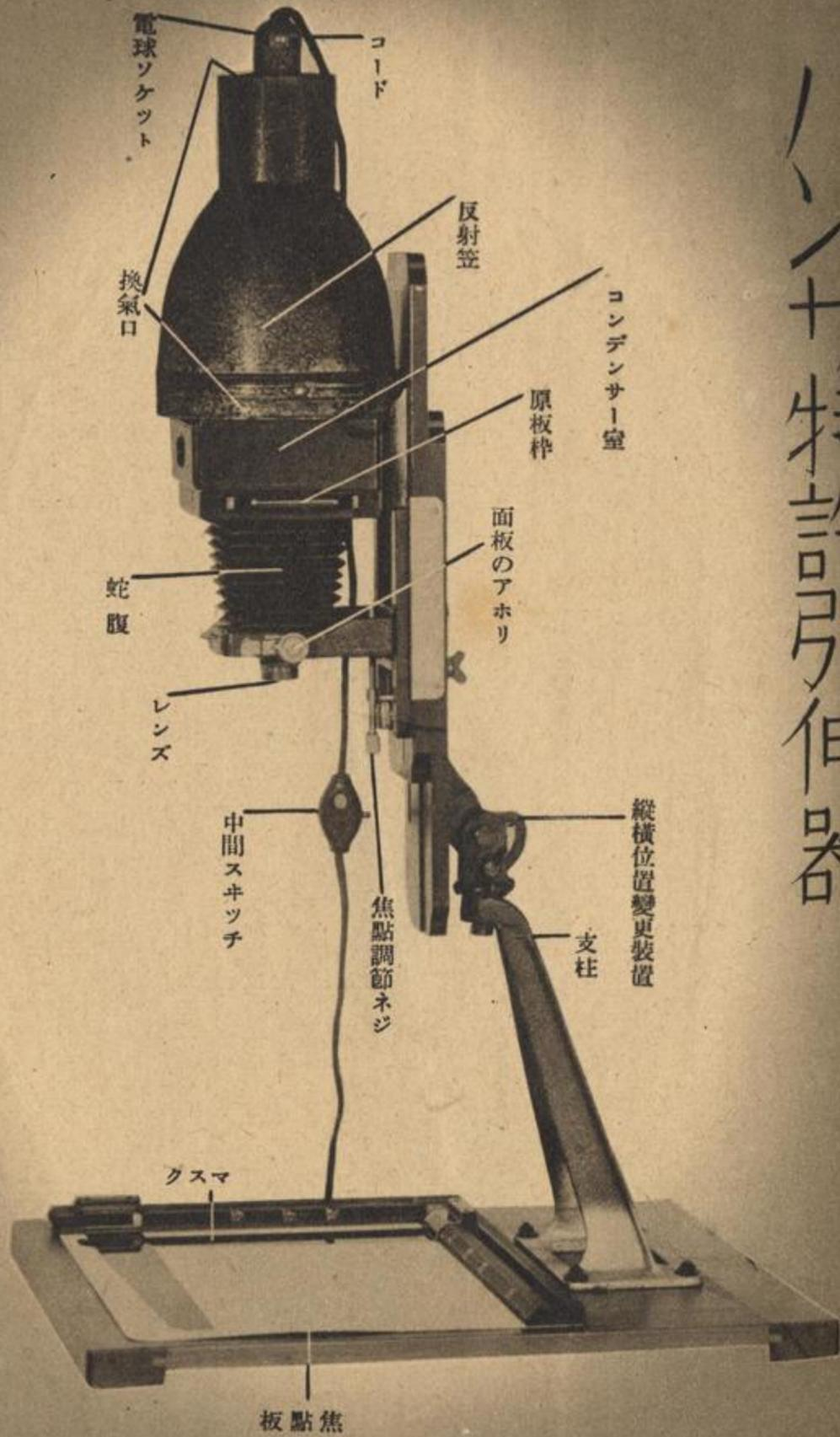
ハンザ特許引伸器は、簡単に縦式にもなり横式にもなる複合機構であります。コンデンサー二枚使用の聚光式でなく、コンデンサー無しで散光式でもない、而も双方の特長を兼ね備へた獨特の様式を創造して居ります。
